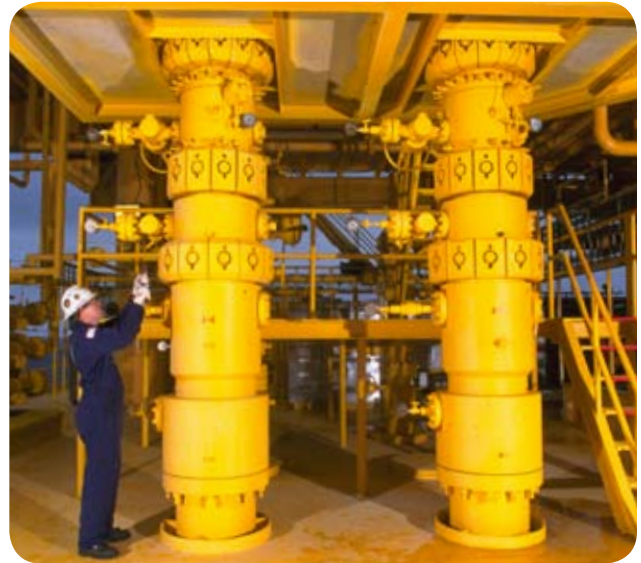
Оборудование с сегментными зажимами Speedloc-II
