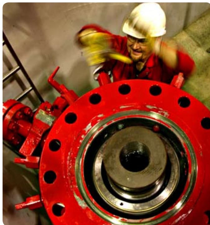
Вид сверху на трубную головку и подвеску НКТ (346 мм)
